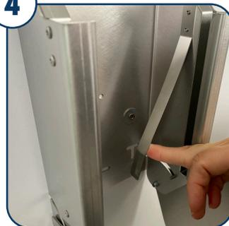
Les plaques d'acier à l'intérieur constituent le système adaptable de déroulement du frein pour une consommation réduite. Vous voulez serrer davantage le frein ? Tirez ensuite un peu les plaques d'acier vers l'intérieur, en fonction de la force avec laquelle vous voulez freiner les rouleaux.
