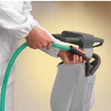
Vispa 35 B-BS Periodieke reiniging van de wisser slang met het oog op optimale zuigwerking
